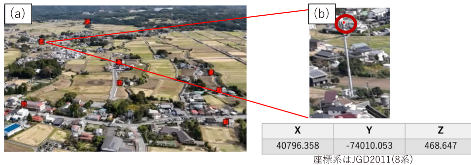
図 4 画像座標 x, y と LiDAR 点群データ (X, Y, Z) の組み合わせの例。(a) には左側画像内の 8 つの画素位置 (赤い四角) を示す。(b) は基準点のひとつである構造物の頂点の座標を LiDAR 点群データで確認した例である。
