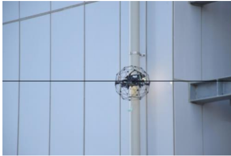
近接飛行による外壁点検の様子
