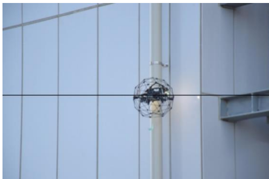
外壁を点検するドローンの様子
