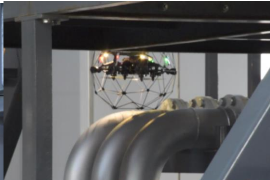
狭小空間を点検するドローンの様子
