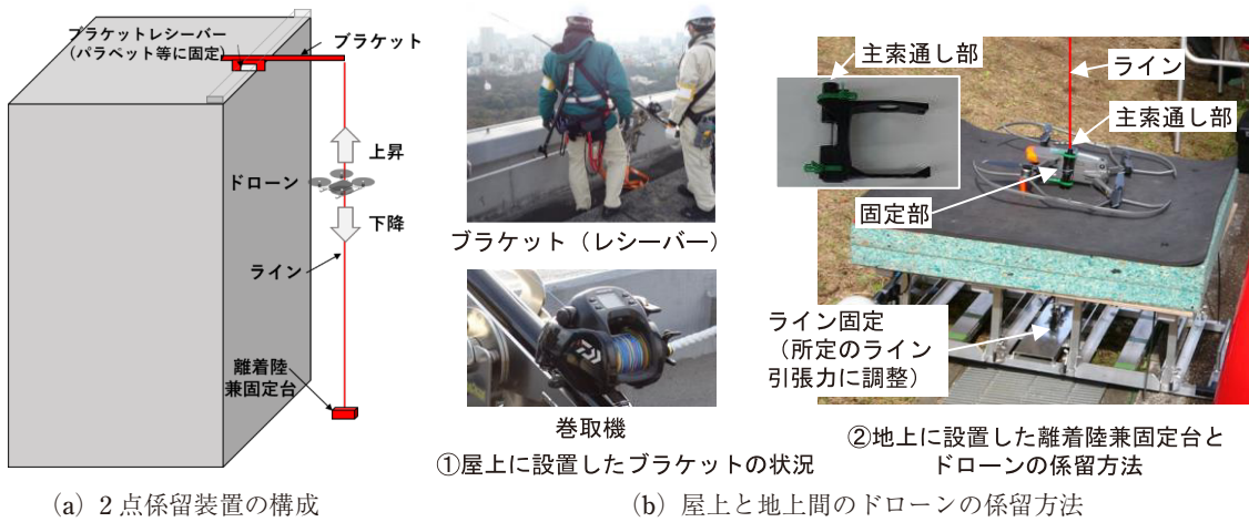
図6 2点係留装置を利用したドローンによる調査概要
