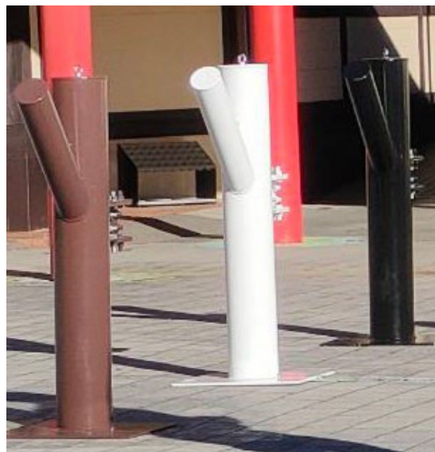
図1 実証に使用した模擬劣化サンプル品の外観
