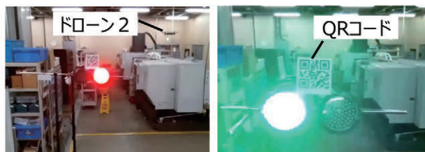
(a) ドローン1：赤信号停止 (b) ドローン1：青信号通過 ドローン2：青信号通過 ドローン2：交差通過後
