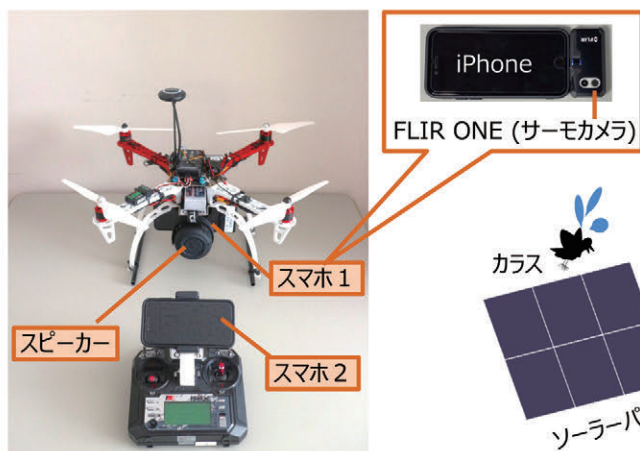
図1. ドローンF450と搭載装備
