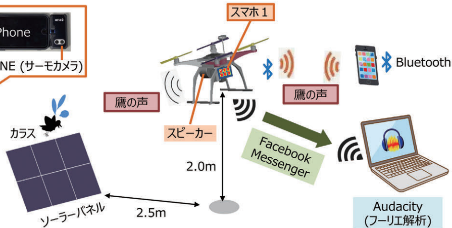
図2. スマホ活用ドローンによる温度計測と鳥獣対策音の発生実験の概要
