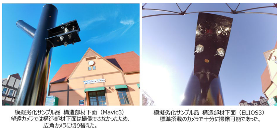
図6 ドローンに搭載した広角カメラによる撮影画像の一例
