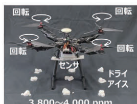
図5. \text{CO}_2 ガス検知実験
